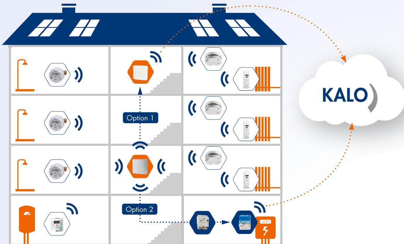
Ein im Treppenhaus installierter Netzwerkknoten empfängt die Verbrauchswerte der Mess- und Erfassungsgeschichten in den Nutzeinheiten. Diese werden sicher und automatisiert per Fernübertragung an KALO weitergeleitet.
